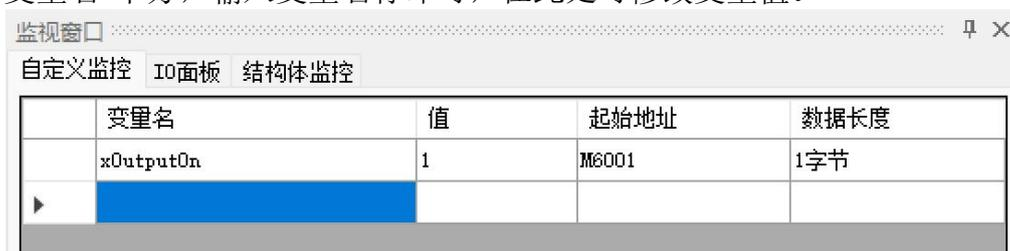
为了方便 IO 的调试, MatriX Control 提供了专用的“IO 面板”监控页面。用户输入 IO 映射的地址,窗口自动按照增量顺序将 IO 状态读取并呈现,同时可以通过双击的方式修改任意一位的状态。
