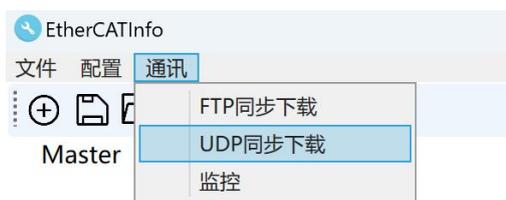
2) 修改通讯配置，MX2000 系列可编程控制器默认 IP 为 192.168.0.122，远程端口默认 2011，本地端口写入 5080（任意端口，不冲突即可）。
